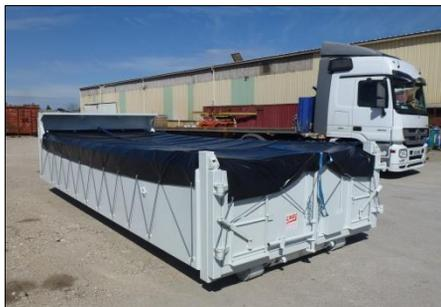
Bâchage Ignifuge type accordéon avec coffre démontable
