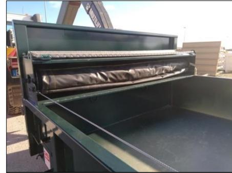
Bâchage Ignifuge par enrouleur avec coffre démontable
